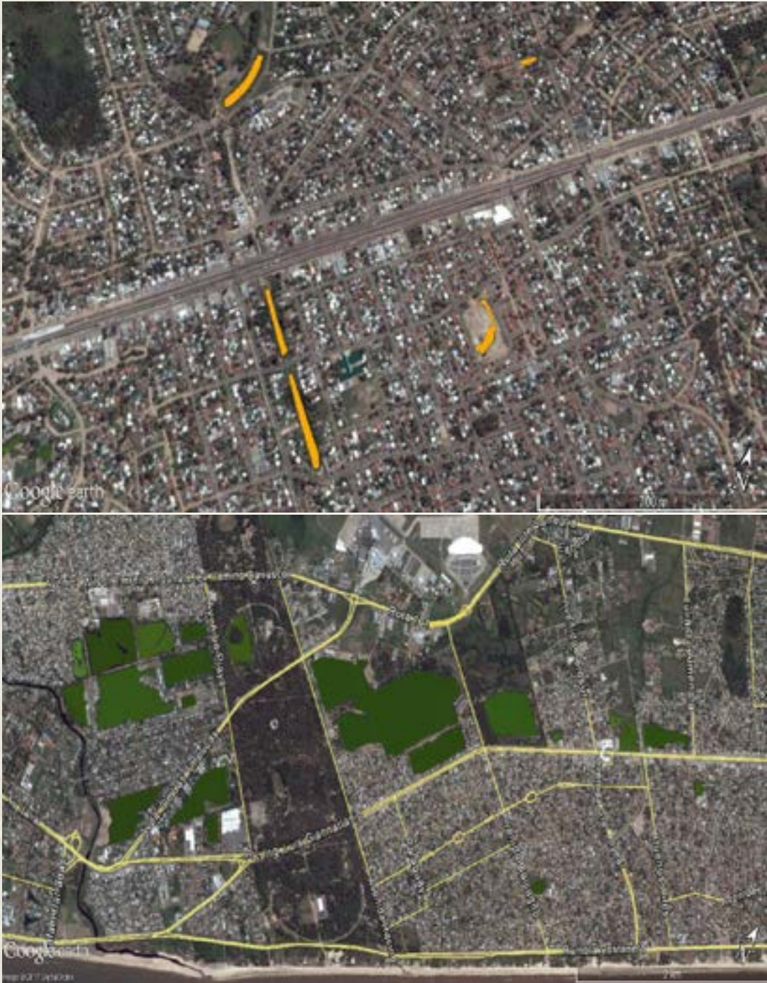
Fig. 18- Lagos de Paso Carrasco y la zona oeste de Ciudad de la Costa (arriba) y de la zona central de Ciudad de la Costa (abajo). Estos últimos fueron construidos recientemente con el objetivo de retener pluviales.
